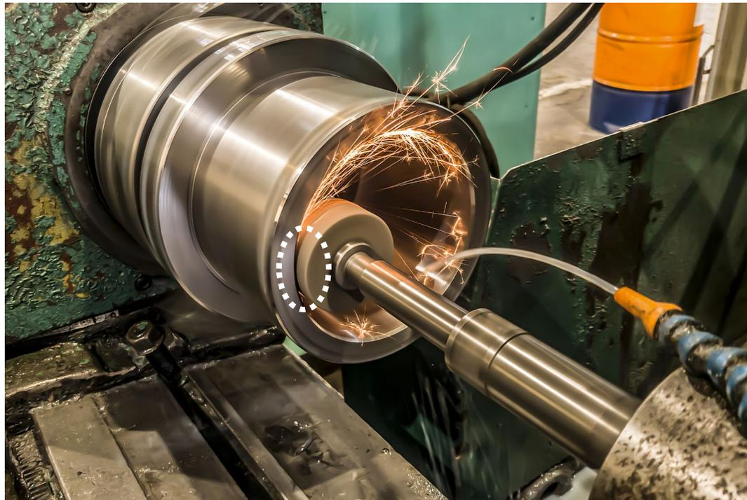
研削による仕上げ(内径研削)
